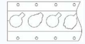
USE STRAIGHT AND UNDAMAGED TRACK AND BARS
