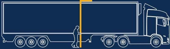
测量货物尺寸至关重要，而且货物尺寸应符合计划行驶路线的法定限高。
